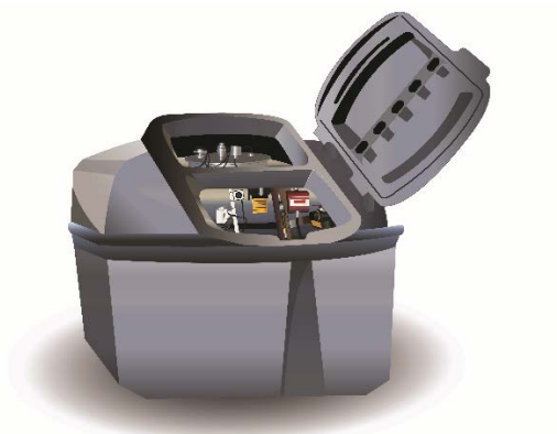
Suuntaa antava piirros avattavasta kaksivaipparakenteesta
